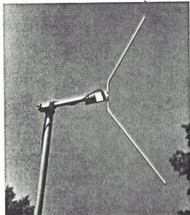
Bild 8: 115°-Winkeldipol für 2 m + 70 cm. Formgebung nach Prof. Popovic. Gewinn: 2 m/0 dB; 70 cm/4,5 dB
